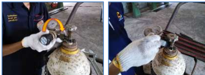
รูปที่ 4.22 แสดงการเปิดวาล์วที่หัวท่อแก๊สออกซิเจน ที่มา : นิโรจน์ เฟ็งศรี, 2562.
