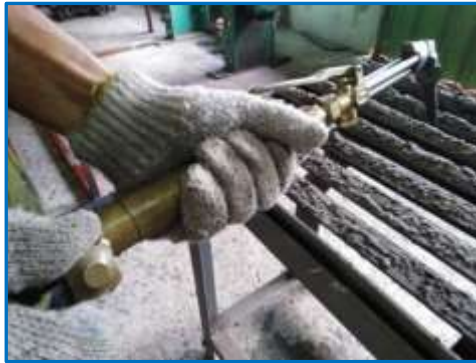
รูปที่ 5.12 แสดงการปรับแก๊สอะเซทิลีน ที่มา : นิโรจน์ เพ็งศรี, 2562.
