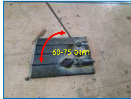
รูปที่ 3.21 แสดงการตั้งมุมของลวดเชื่อมที่ถูกต้อง (Correct Angle of Electrode)
