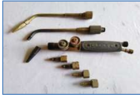
รูปที่ 4.7 แสดงหัวเชื่อมแก๊ส (Welding Torch)
