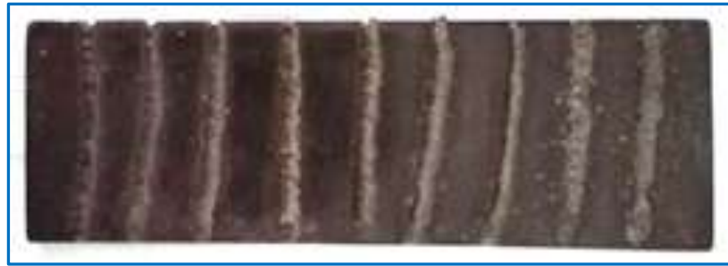
รูปที่ 3.18 แสดงระยะอาร์กที่ถูกต้อง (Correct Arc length) ที่มา : นิโรจน์ เพ็งศรี, 2562.
