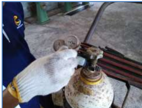
รูปที่ 4.14 แสดงการตรวจเช็คความเรียบร้อยของเกลียวที่ท่อแก๊ส
