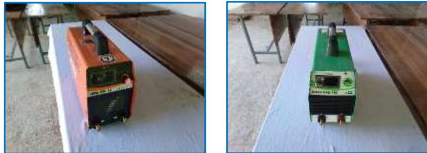
รูปที่ 3.7 แสดงเครื่องเชื่อมแบบอินเวอร์เตอร์ (Inverter Welding) ที่มา : นิโรจน์ เฟ็งศรี, 2562.
