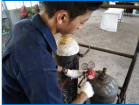
รูปที่ 4.36 แสดงใช้ประแจปากตายขันเกลียวข้อต่อแก๊ส เข้าเครื่องปรับความดันแก๊สอะเซทิลีน ที่มา : นิโรจน์ เฟ็งศรี, 2562.
