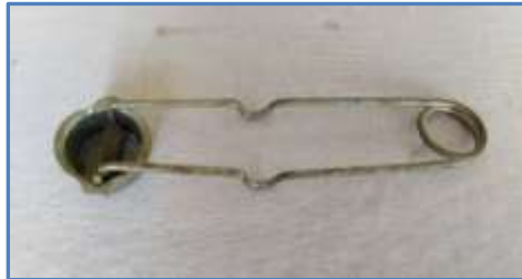
รูปที่ 4.9 แสดงอุปกรณ์จุดไฟ (Friction Lighter)
