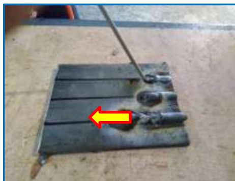
รูปที่ 3.24 แสดงวิธีการเริ่มต้นและสิ้นสุดรอยเชื่อม
