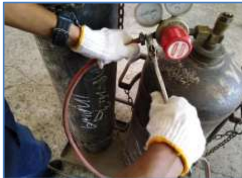
รูปที่ 4.18 แสดงประกอบสายยางเชื่อมแก๊สสีแดงเข้ากับข้อต่อทางออกแก๊ส ที่มา : นิโรจน์ เฟื่องศรี, 2562.
