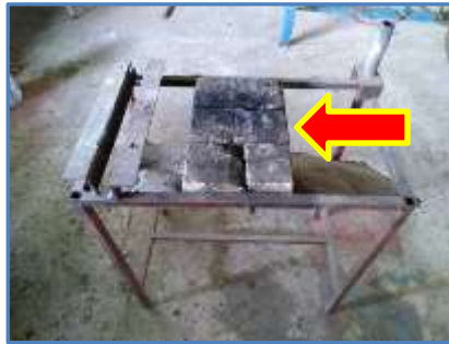
รูปที่ 1.5 แสดงโตะสำหรับฝึกปฏิบัติงานเชื่อมแก๊สจะต้องปูด้วยอิฐทนไฟ
