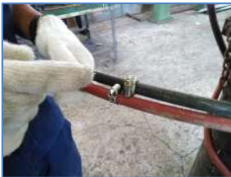
รูปที่ 4.20 แสดงหัวเชื่อมแก๊สนำอุปกรณ์ห้องผสมแก๊สมาต่อเข้ากับหัวเชื่อมแก๊ส ที่มา : นิโรจน์ เฟ็งศรี, 2562.
