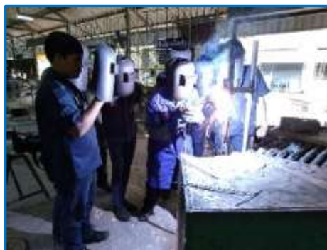
รูปที่ 1.2 แสดงรังสีจากการเชื่อมไฟฟ้า ที่มา : นิโรจน์ เฟ็งศรี, 2562.
