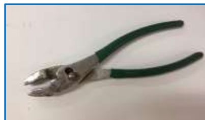
รูปที่ 3.17 แสดงคีมจับชิ้นงานร้อน (Pliers)
