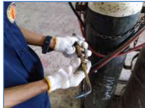
รูปที่ 4.20 แสดงหัวเชื่อมแก๊สนำอุปกรณ์ห้องผสมแก๊สมาต่อเข้ากับหัวเชื่อมแก๊ส ที่มา : นิโรจน์ เฟ็งศรี, 2562.
