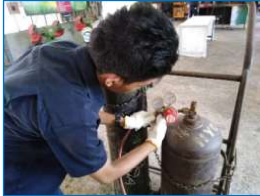
รูปที่ 4.34 แสดงปิดเครื่องปรับความดันแก๊สที่ตรงข้อต่อใช้ประแจปากตายขันนัต จากสายยางเชื่อม แก๊สอะเซทิลีน
