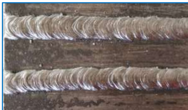
รูปที่ 3.20 แสดงการใช้ความเร็วการเดินทางเชื่อมที่ถูกต้อง (Correct Travel Speed) ที่มา : นิโรจน์ เพ็งศรี, 2562.
