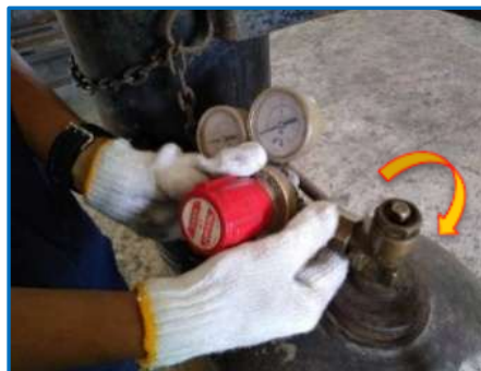
รูปที่ 4.28 แสดงปิดวาล์วที่หัวท่อบรรจุแก๊สอะเซทิลีน ที่มา : นิโรจน์ เฟ็งศรี, 2562.
