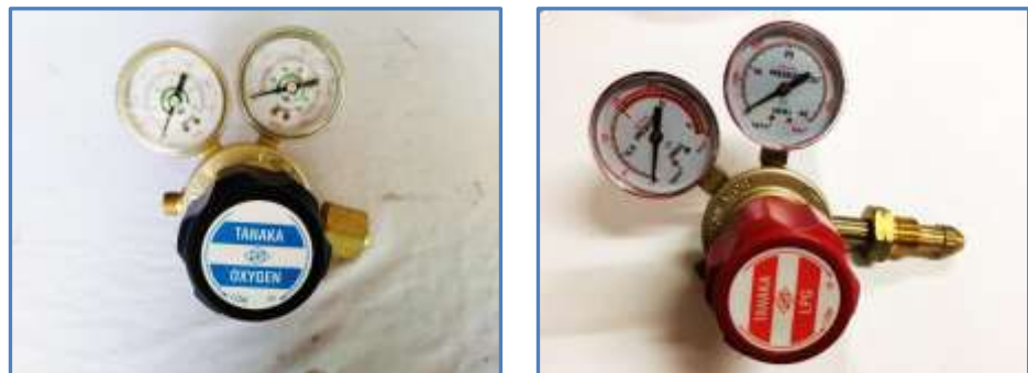
รูปที่ 4.4 แสดงเครื่องปรับความดันแก๊สออกซิเจนและอะเซทิลีน
