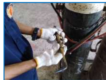
รูปที่ 5.8 แสดงการจุดเปลวไฟที่หัวตัดแก๊ส
