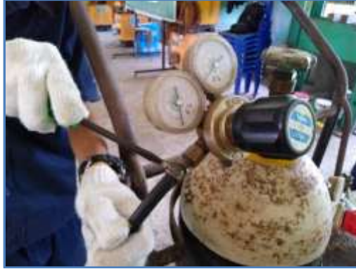
รูปที่ 4.17 แสดงประกอบสายยางเชื่อมแก๊สสีเขียวเข้ากับข้อต่อทางออกแก๊ส ที่มา : นิโรจน์ เฟื่องศรี, 2562.
