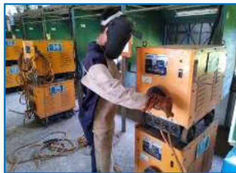
รูปที่ 3.19 แสดงการตั้งกระแสไฟฟ้าที่ถูกต้อง (Correct Current) ที่มา : นิโรจน์ เพ็งศรี, 2562.
