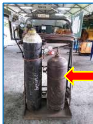
รูปที่ 1.6 แสดงท่อแก๊สอะเซทิลีนและท่อแก๊สออกซิเจนจะต้องยึดผูกมัดให้ติดกับโตะ รถเข็น หรือผนังเพื่อป้องกันไม่ให้ท่อล้มแล้วอาจจะเกิดอุบัติเหตุได้
