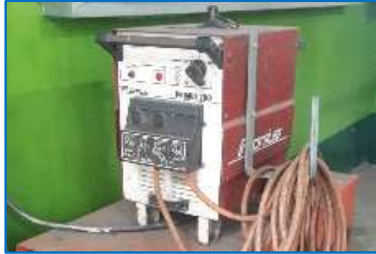
รูปที่ 3.4 แสดงเครื่องเชื่อมแบบหม้อแปลง-เครื่องเรียงกระแส ที่มา : นิโรจน์ เฟ็งศรี, 2562.
