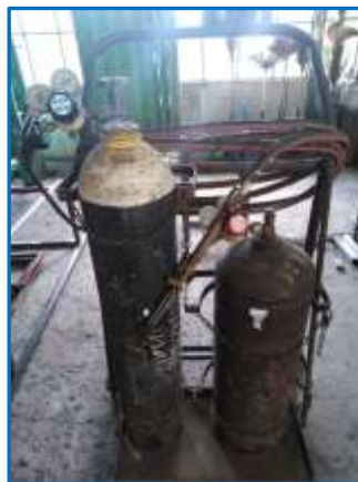
รูปที่ 5.14 แสดงการปรับแก๊สอะเซทิลีน ที่มา : นิโรจน์ เพ็งศรี, 2562.
