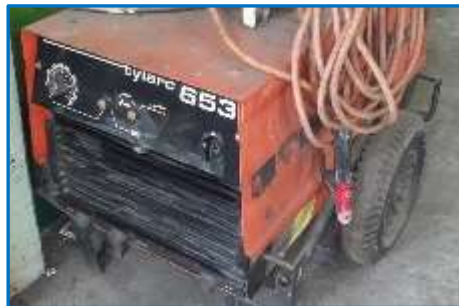
รูปที่ 3.5 แสดงเครื่องเชื่อมแบบใช้มอเตอร์เป็นต้นกำลังขับ ที่มา : นิโรจน์ เฟ็งศรี, 2562.
