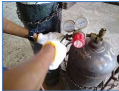
รูปที่ 4.30 แสดงเปิดวาล์วแก๊สอะเซทิลีนที่หัวเชื่อมแก๊สโดยหมุนทวนเข็มนาฬิกา ที่มา : นิโรจน์ เฟ็งศรี, 2562.
