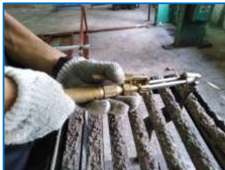
รูปที่ 5.11 แสดงการปรับแก๊สอะเซทิลีน ที่มา : นิโรจน์ เพ็งศรี, 2562.
