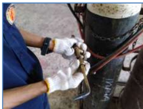
รูปที่ 4.31 แสดงปิดหัวเชื่อมแก๊สหมุนหัวทิพที่ต่อกับกล่องผสมแก๊สโดยหมุนทวนเข็มนาฬิกา ที่มา : นิโรจน์ เฟ็งศรี, 2562.
