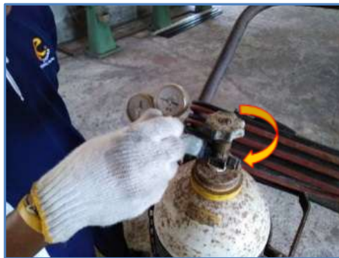
รูปที่ 4.23 แสดงการเปิดวาล์วท่อแก๊สอะเซทิลีน ที่มา : นิโรจน์ เฟ็งศรี, 2562.
