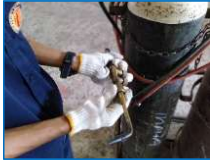
รูปที่ 5.9 แสดงการปรับแก๊สอะเซทิลีน ที่มา : นิโรจน์ เพ็งศรี, 2562.
