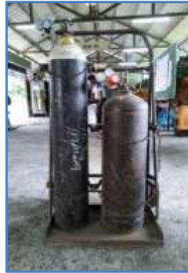
รูปที่ 4.11 แสดงการยึดท่อบรรจุแก๊สด้วยโซ่เพื่อป้องกันท่อแก๊สล้มและกระแทก
