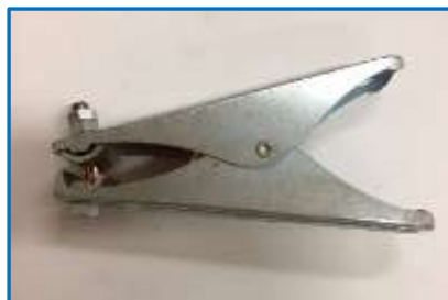
รูปที่ 3.12 แสดงอุปกรณ์จับยึดสายดิน (Ground Clamp)
