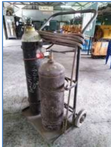
รูปที่ 4.37 แสดงม้วนสายยางเชื่อมแก๊สเก็บอุปกรณ์ที่ใช้ในงานเชื่อมแก๊สให้เรียบร้อย ที่มา : นิโรจน์ เฟ็งศรี, 2562.
