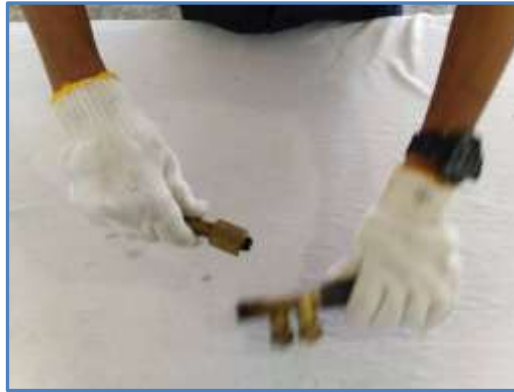
รูปที่ 4.32 แสดงปิดหัวเชื่อมแก๊สห้องผสมแก๊สโดยหมუნทวนเข็มนาฬิกา ที่มา : นิโรจน์ เฟ็งศรี, 2562.
