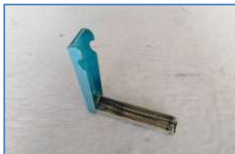
รูปที่ 4.10 แสดงอุปกรณ์ทำความสะอาดหัวทิวเชื่อม (Tip Cleaner)
