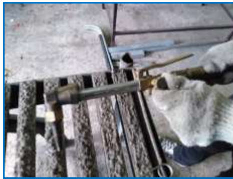
รูปที่ 5.13 แสดงการปรับแก๊สอะเซทิลีน ที่มา : นิโรจน์ เพ็งศรี, 2562.
