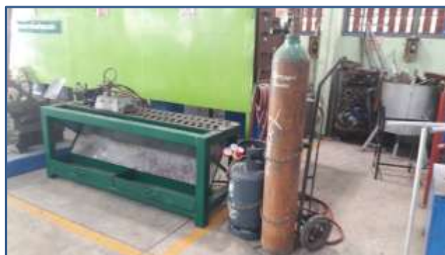
รูปที่ 5.16 แสดงการตัดแก๊สโดยเครื่องตัดอัตโนมัติ
