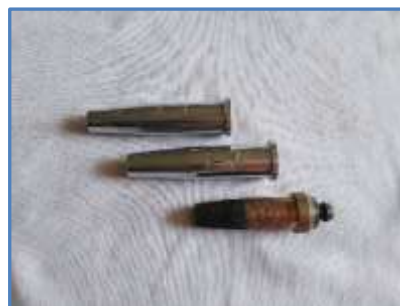
รูปที่ 5.4 แสดงหัวตัดแก๊สแบบสมดุลความดัน ที่มา : นิโรจน์ เฟ็งศรี, 2562.
