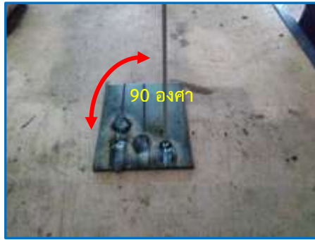
รูปที่ 3.21 แสดงการตั้งมุมของลวดเชื่อมที่ถูกต้อง (Correct Angle of Electrode)
