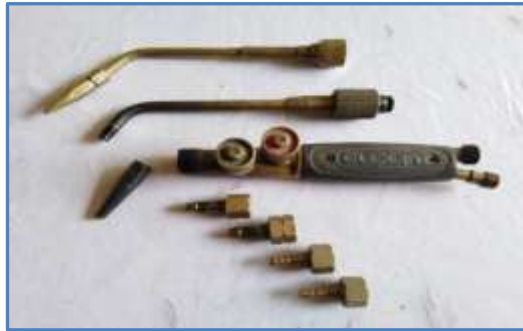
รูปที่ 4.21 แสดงอุปกรณ์หัวทิฟเชื่อมมาประกอบต่อโดยหมุนหัวทิฟเชื่อมตามเข็มนาฬิกา ที่มา : นิโรจน์ เฟ็งศรี, 2562.
