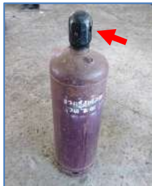
รูปที่ 4.12 แสดงฝาครอบหัวท่อแก๊สออกซิเจนและแก๊สอะเซทิลีน
