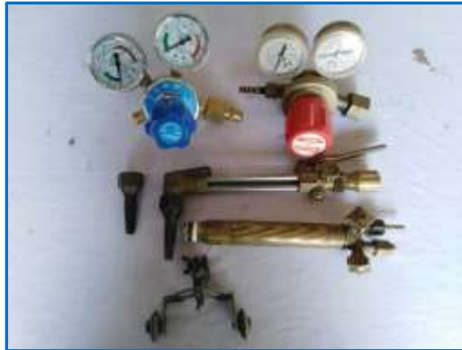
รูปที่ 5.2 แสดงอุปกรณ์ที่ใช้ในงานตัดแก๊ส ที่มา : นิโรจน์ เฟ็งศรี, 2562.
