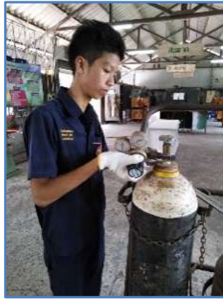
รูปที่ 4.29 แสดงการเปิดวาล์วแก๊สออกซิเจนที่หัวเชื่อมแก๊สโดยหมุนทวนเข็มนาฬิกา ที่มา : นิโรจน์ เฟ็งศรี, 2562.
