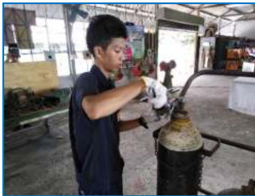
รูปที่ 4.35 แสดงใช้ประแจปากตายขันเกลียวข้อต่อแก๊สเครื่องปรับความดันแก๊สออกซิเจน
