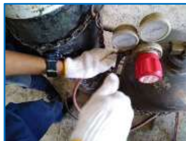
รูปที่ 5.7 แสดงการเปิดวาล์วแก๊สอะเซทิลีน
