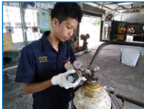
รูปที่ 4.33 แสดงปิดเครื่องปรับคุมความดันแก๊สออกซิเจนตรงข้อต่อทางออกแก๊สใช้ประแจปากตาย ที่มา : นิโรจน์ เฟ็งศรี, 2562.
