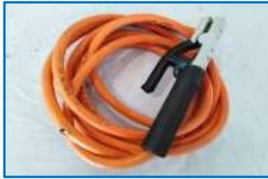
รูปที่ 3.11 แสดงสายเชื่อม (Cables)
