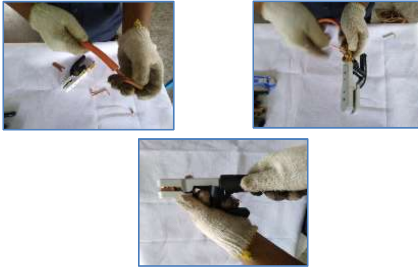
รูปที่ 3.18 แสดงการเตรียมเครื่องมืออุปกรณ์งานเชื่อมไฟฟ้า
