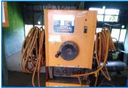
รูปที่ 3.3 แสดงเครื่องเชื่อมแบบหม้อแปลงไฟฟ้า (Tranformer Weiding Machine)
