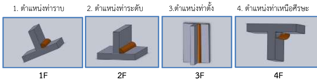
รูปที่ 2.5 แสดงท่าเชื่อมตามแบบของมาตรฐานอเมริกา AWS ที่มา : นิโรจน์ เฟ็งศรี, 2562.
