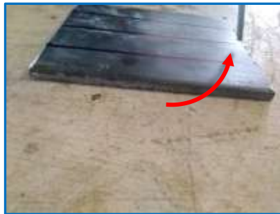
รูปที่ 3.23 แสดงวิธีขีดอาร์ก (Scratching)
