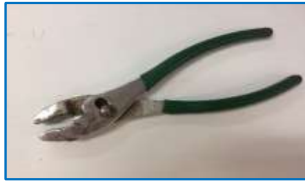
รูปที่ 3.17 แสดงคีมจับชิ้นงานร้อน (Pliers)
