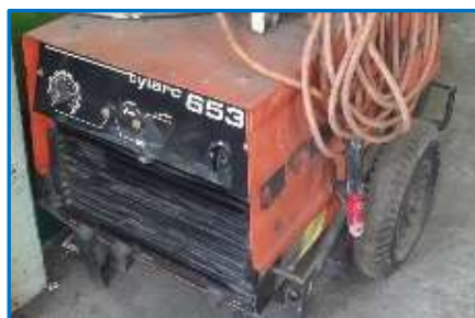
รูปที่ 3.5 แสดงเครื่องเชื่อมแบบใช้มอเตอร์เป็นต้นกำลังขับ
