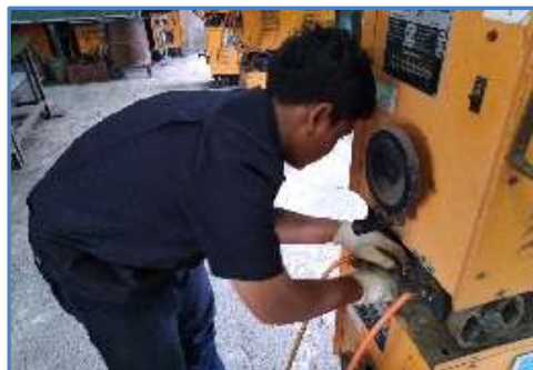
รูปที่ 3.18 แสดงการต่อสายเชื่อมกับขั้วเครื่องเชื่อมไฟฟ้า
