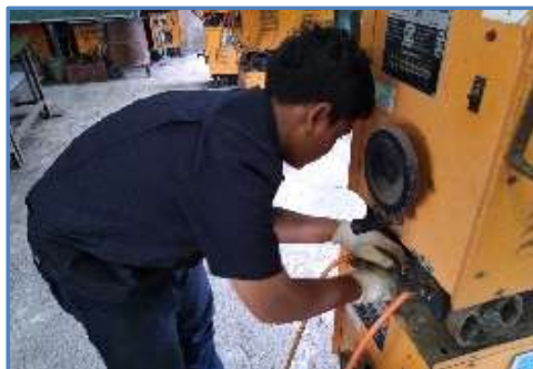
รูปที่ 3.18 แสดงการต่อสายเชื่อมกับขั้วเครื่องเชื่อมไฟฟ้า
